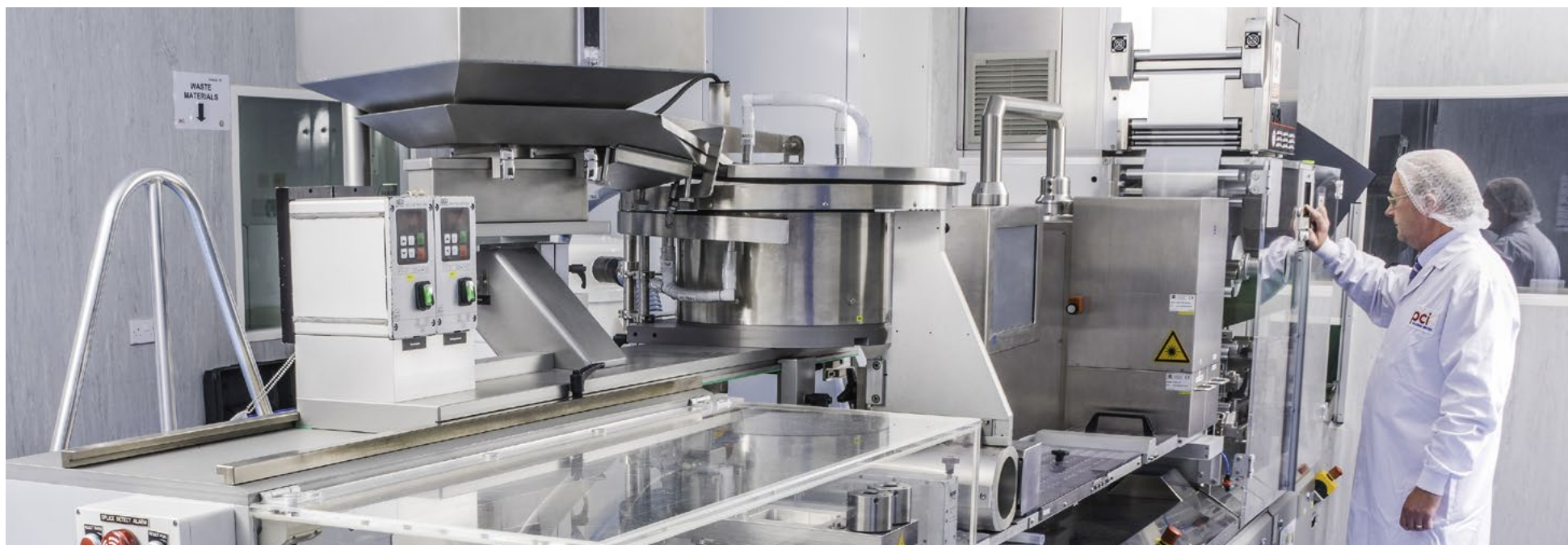
Drucksysteme von Hapa werden bei PCI an den Noack-Linien in grossem Umfang eingesetzt. So zum Beispiel bei dieser Blisterlinie, wo ein aufgesetzter Hapa 226 einfarbig auf Folie druckt.
