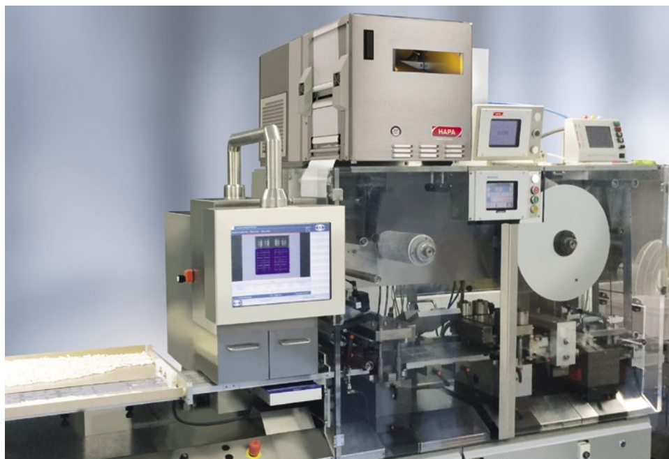
Ein weiteres UV-Flexo-Drucksystem im Einsatz auf einer Blisterlinie. PCI bevorzugt den Inline-Druck, weil er den Prozess vereinfacht sowie Abfälle und Lagerhaltungsaufwand reduziert.
